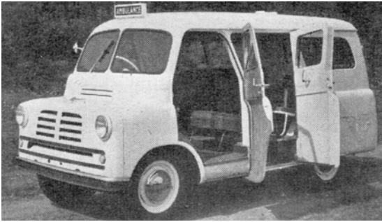
De ambulance op deze foto's kan gebruikt worden voor liggend en zittend vervoer. De bouwer is de firma Martin Walter.
