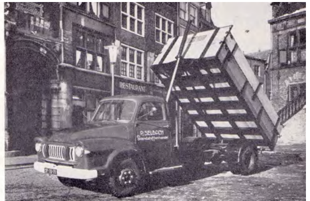
Onder: deze houten kipper is geplaatst op een 4-tons chassis met een wielbasis van 407cm. De verhoging van de zijwanden is snel te verwijderen.
