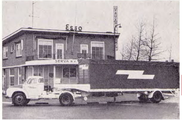
Boven: de trekkracht voor deze oplegger-combinatie is een ingekort 6-tons chassis met een 5 liter dieselmotor. De oplegger is ontworpen voor een maximale last van 8 ton. De combinatie behoort toe aan een bedrijf in Amersfoort.
