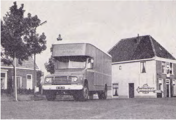
Boven: een houten opbouw zoals deze – gefotografeerd in Monnickendam – is niet ongebruikelijk op het continent. In dit geval is de opbouw geïsoleerd ten behoeve van het vervoer van bederfelijke waren.
