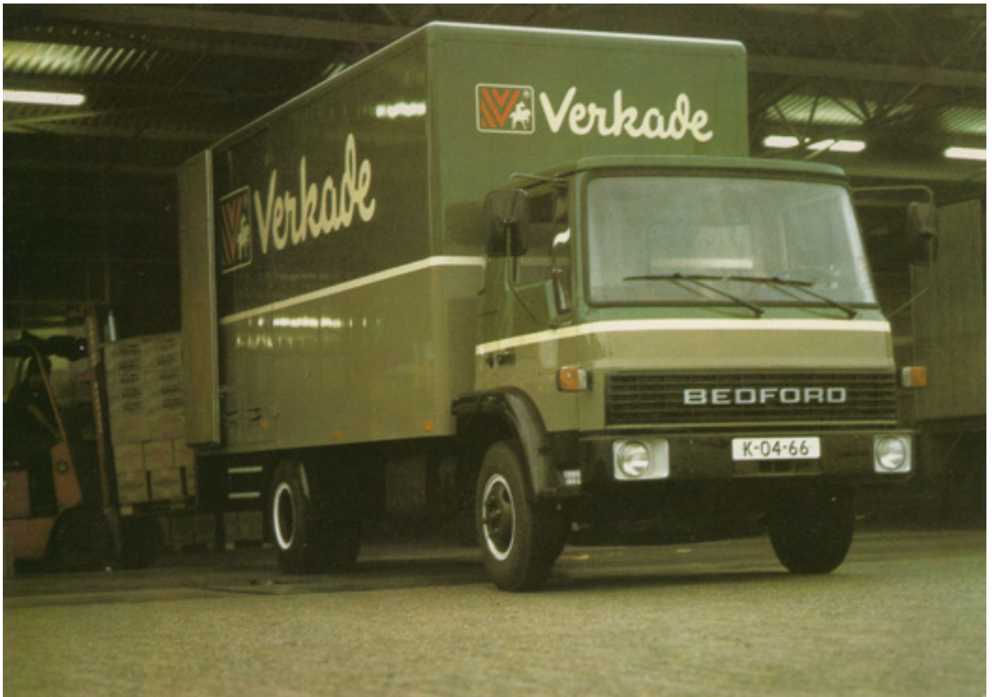
Bedford Reclame foto begin jaren '80. We zien een Bedford TL 860, met een 100pk 5,42l dieselmotor, nog met een tijdelijk kenteken maar al wel gespoten in de Verkade kleuren en met Verkade belettering.
