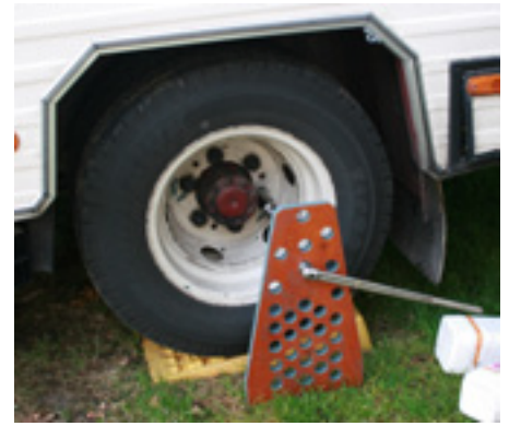
Handig hulpje bij het los- en vastdraaien van wielbouten en -moeren. Geniaal gemaakt door ons clublid Jan Scholte. Dit werkt ook als u geen Bedford heeft!.
